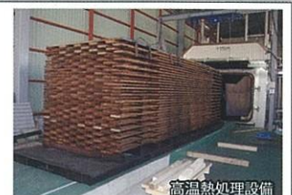
高温熱処理設備
